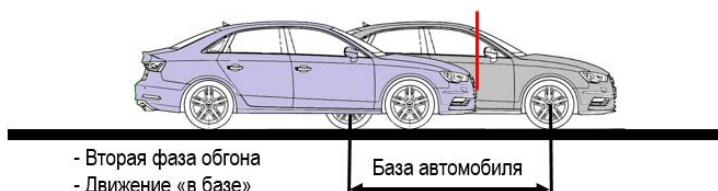
Рис. 1.4 Взаимное положение автомобилей при обгоне: фазы обгона, движение «в базе».
